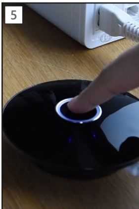
Podłącz Smart Hub do zasilania. Naciśnij i przytrzymaj centralny przycisk aż dioda LED zacznie migać na czerwono
